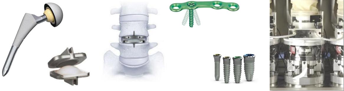
Zu den Prüfgegenständen zählen neuartige Schrauben- und Plattensysteme, Gelenkersatzimplantate wie Hüft- und Bandscheibenprothesen und dynamische Fixationssysteme. Sie werden in Festigkeits-, Ermüdungs- und Abriebtests auf ihre mechanischen Eigenschaften hin untersucht.
